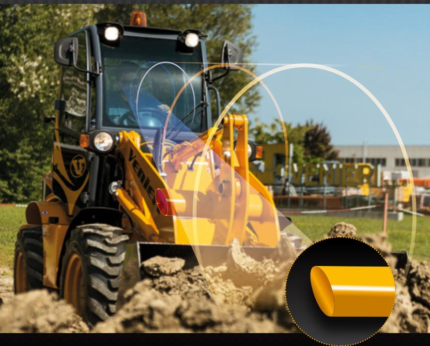
**Connessione bracci a sezione ovalizzata.**
